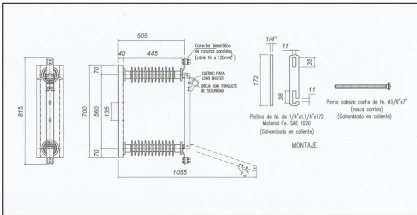
Seccionador unipolar para exterior, tipo SEG-1-UGE-m
