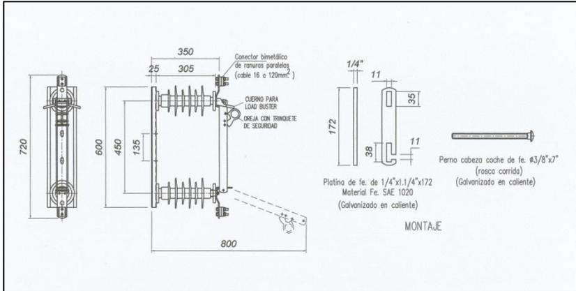
Seccionador unipolar para exterior, tipo SEG-1-UGE-m
